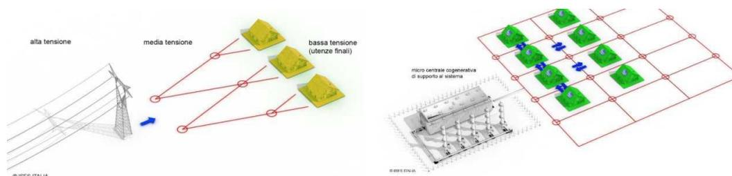
Figura 27- Evoluzione dei sistemi di generazione e distribuzione dell'energia elettrica, del calore (del freddo) con micro-co(tri)-generazione distribuita che vada a sostituire il sistema dei mega impianti di produzione di energia.
