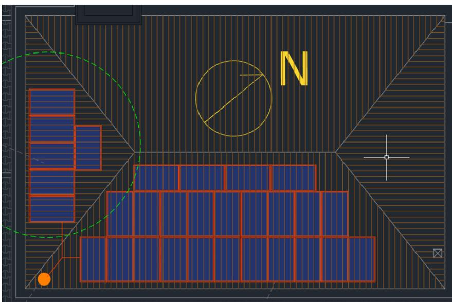
Fig. 5: Posizionamento dei moduli del generatore
