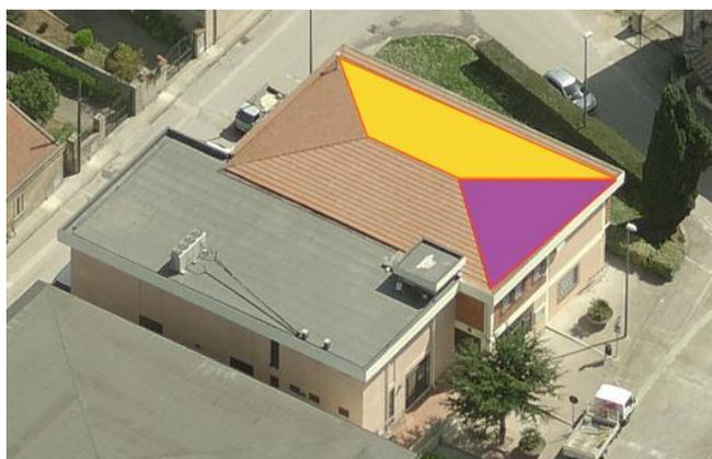
La superficie è tale da poter installare la potenza di pico pari a 13.5 kWp per una produzione di energia
