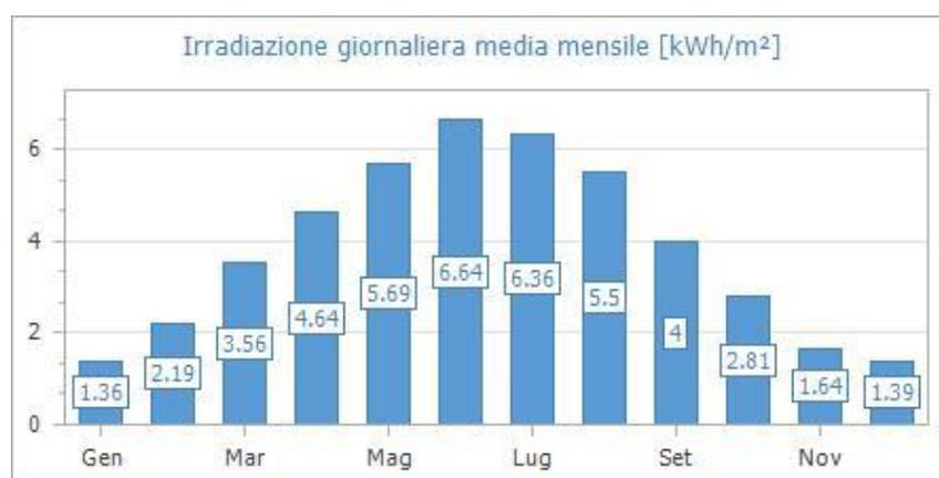
Fig. 1: Irradiazione giornaliera media mensile sul piano orizzontale [kWh/m<sup>2</sup>]- Fonte dati: UNI 10349:2016 - Stazione di rilevazione: Sassari
